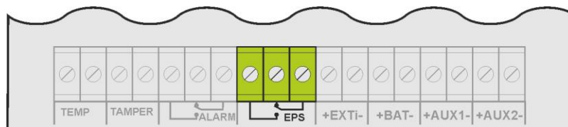
Rys. 8. Wyjście techniczne EPS.
