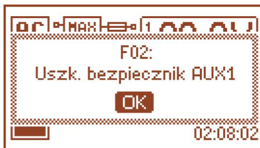
Rys. 18. Komunikat sygnalizujący przepalenie bezpiecznika na wyjściu AUX1.
