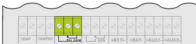
Rys. 8. Wyjście techniczne ALARM.
